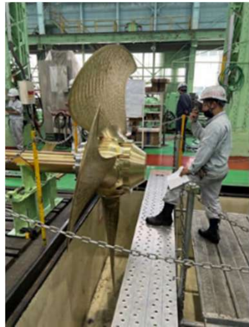
写真5 CPP 作動試験最大翼角
