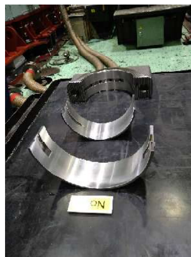
写真 7 開放したクランクピンメタル
