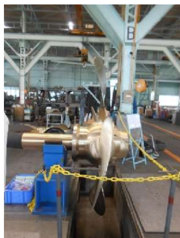
写真4 作動試験における翼角変化の状況(後進 → 中立 → 前進)
