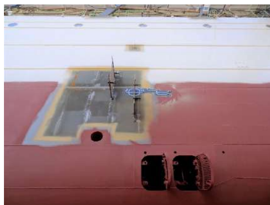
図-7 乾舷標取付位置確認検査
