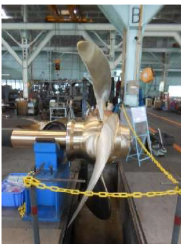
写真4 作動試験における翼角変化の状況(後進 → 中立 → 前進)
