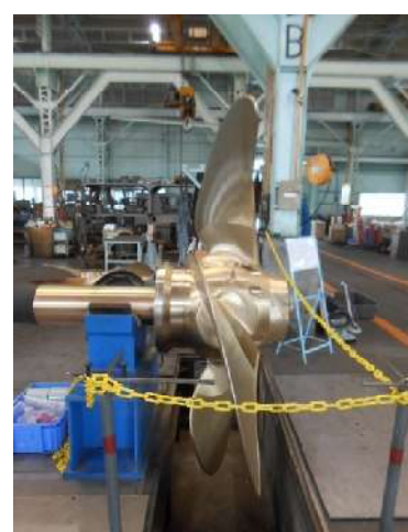
写真4 作動試験における翼角変化の状況(後進 → 中立 → 前進)
